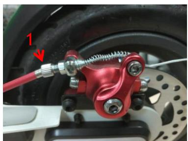
**2.** Girando el ajuste 2 acercamos o alejamos la zapata 4 al disco. Este ajuste lo podemos realizar con la llave allen proporcionada con el equipo.
