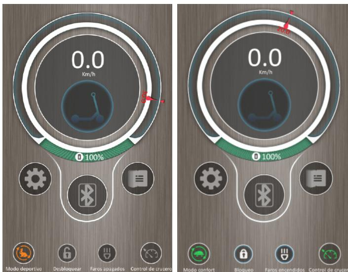
Para el modo de velocidad, puede ver las diferentes marcas de la misma. El dibujo de "Conejo" indica el modo de velocidad deportiva-máxima; El dibujo de "Tortuga verde" que indica el modo CONFORT-ECO.
