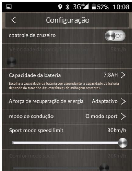
O ícone “configuração” indica o modo de control de cruzeiro – CRUISER MODE- escolhendo a velocidade que você deseja viajar para controlar a e-scooter.
