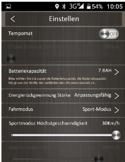
Das Symbol "Konfiguration" zeigt den Tempomatmodus an und wählt die gewünschte Geschwindigkeit, um den E-Roller zu steuern.
