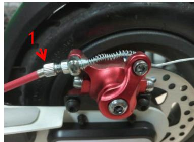
**2.** Durch Drehen der Einstellung 2 wird das Teil 4 näher an die Scheibe herangeführt. Diese Einstellung kann mit dem mitgelieferten Inbusschlüssel vorgenommen werden.
