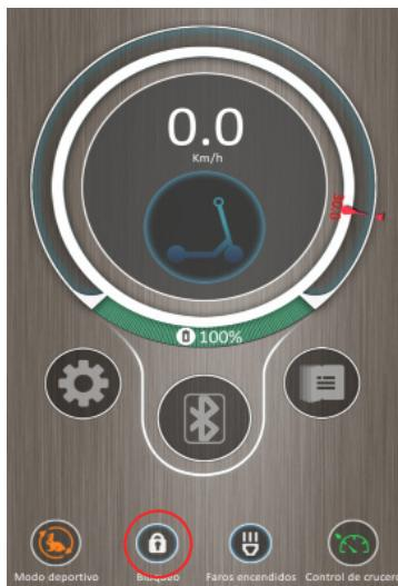
Wenn das Schlosssymbol aufleuchtet (Riegel geschlossen), verriegelt der Roller, wenn er nicht leuchtet, zeigt er das Entriegeln (offener Bolzen).
