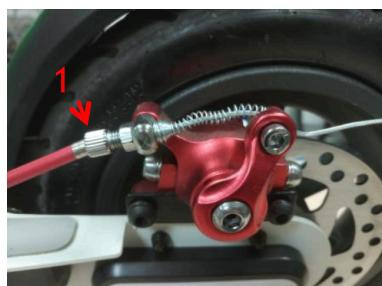
**2.** En tournant le réglage 2, nous déplaçons le sabot de frein 4 plus près ou plus loin du disque de frein. Ce réglage peut être effectué à l'aide de la clé Allen fournie avec le matériel.
