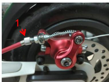
**2.** Girar o ajuste 2 aproxima a peça 4 ao disco. Este ajuste pode ser feito com a chave allen fornecida com o equipamento.
