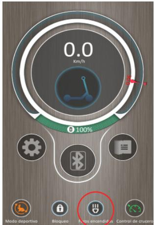
Podrá encender o apagar a través de su smartphone la luz delantera del e-scooter. Cuando se ilumina el ícono de la luz frontal de la aplicación, eso muestra que la luz está encendida, si no está iluminado el ícono, la luz frontal del e-scooter está apagada.
