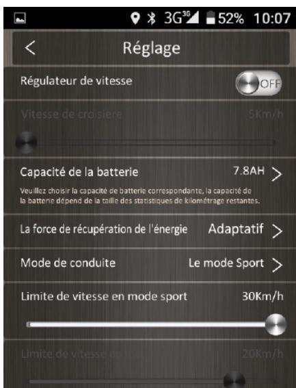
L'icône "configuration" indique le mode de régulation de vitesse, en choisissant la vitesse à laquelle vous souhaitez aller, pour contrôler la trottinette électrique.
